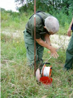
*Il "freatimetro" utilizzato per misurare la soggiacenza della falda.*
